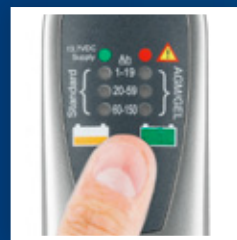
Välj rätt läge, batteristorlek (Ah) och batteriteknologi (AGM/GEL eller standardbatteri). Alternativt 13,7 V Supply.
