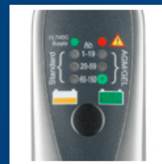
När grönt ljus tänds på det valda läget är batteriet färdigladdat.
